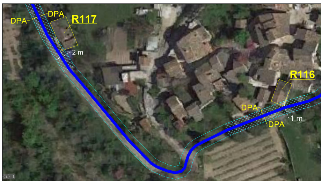
Figura 25 – Fasce di rispetto del cavidotto di evacuazione nei pressi dei ricettori R116 e R117
