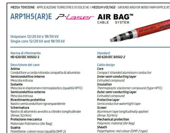
Sezione tipo del cavo in MT – 30 kV – ARPIH5(AR)E
