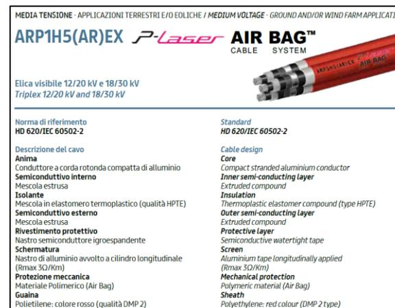
Sezione tipo del cavo in MT – 30 kV – ARPIH5(AR)EX
