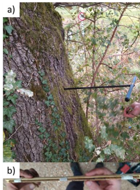
Figura 3. a) prelievo di una carota legnosa con il succhiello di Pressler. b) Campione estratto riposto su un supporto di legno.
