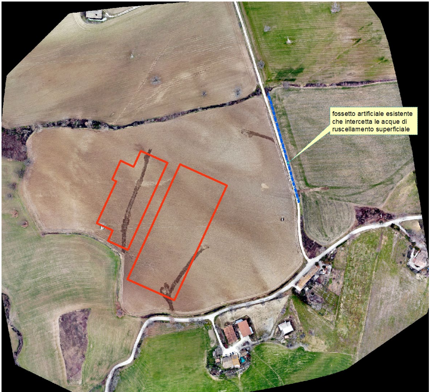
Figura 36 posizione del fosso artificiale bodo strada che raccoglie gran parte delle acque che scende da monte
