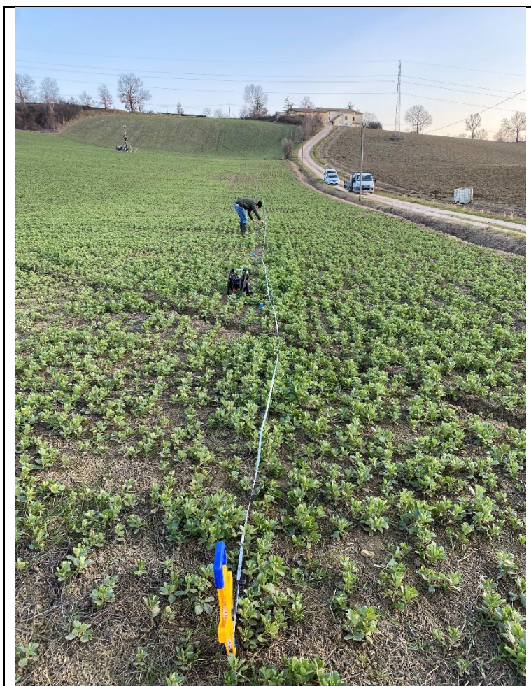
Figura 28 cantiere prova MASW
