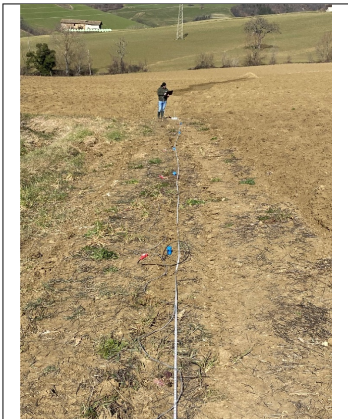
Figura 29 cantiere prova MASW
