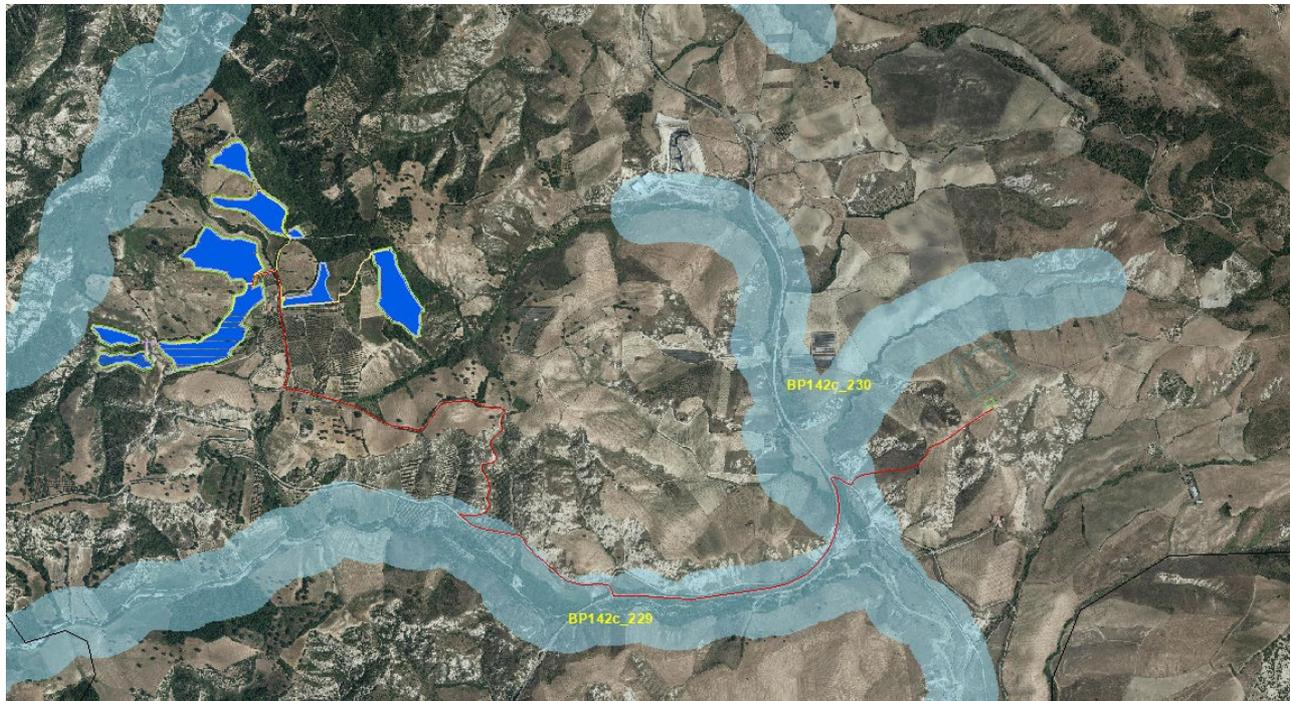
Figura 3.4. – Dettaglio dell’Interferenza del Cavidotto (in rosso) con il bene tutelato “lettera c” D. Lgs. 42/2004.
