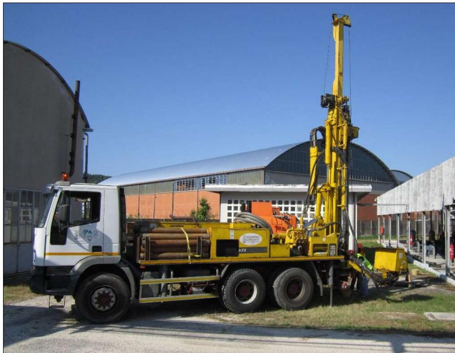
**Figura 2.1** Sonda perforatrice durante l'esecuzione del sondaggio S4
