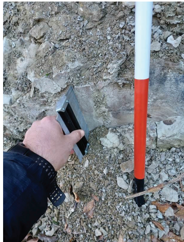
Figura 5-8 Misura con pettine di Barton
