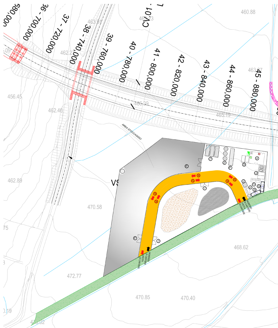
Figura 8.14 - Layout del CO01 (cantiere operativo)
