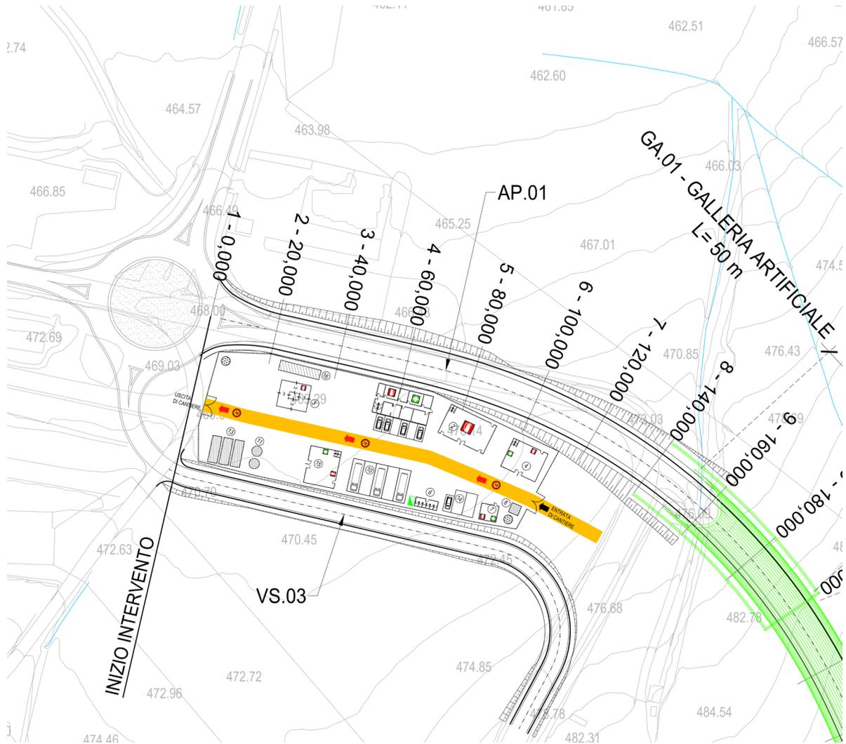
**Figura 4 – Layout cantiere base CB01 (cantiere base)**
