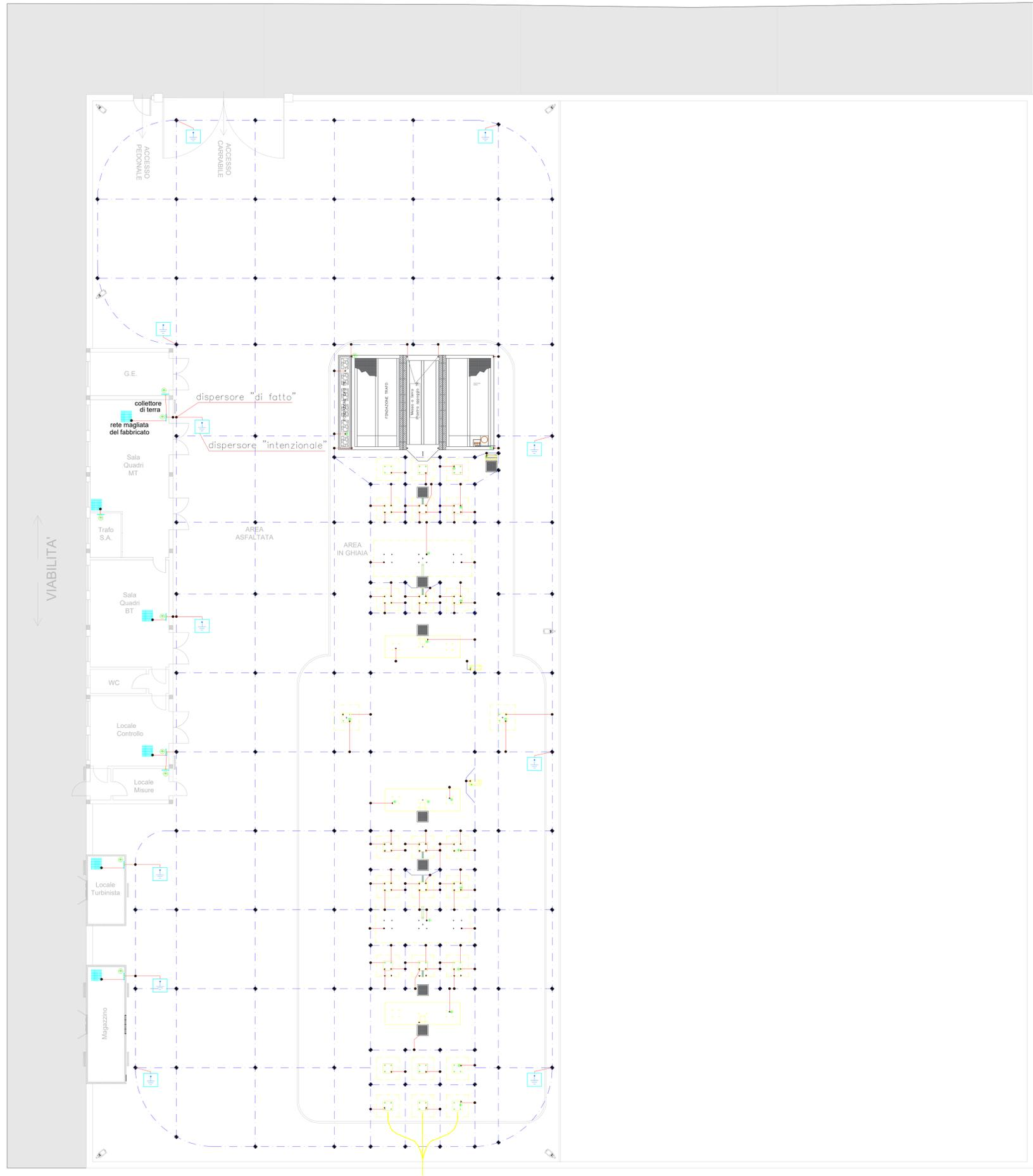
PLANIMETRIA GENERALE DELL'IMPIANTO DI TERRA DELLA SOTTOSTAZIONE ELETTRICA UTENTE
