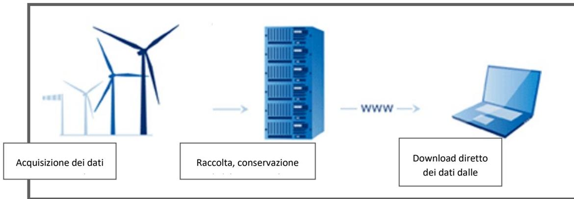
Figura 1. Architettura di un sistema SCADA
