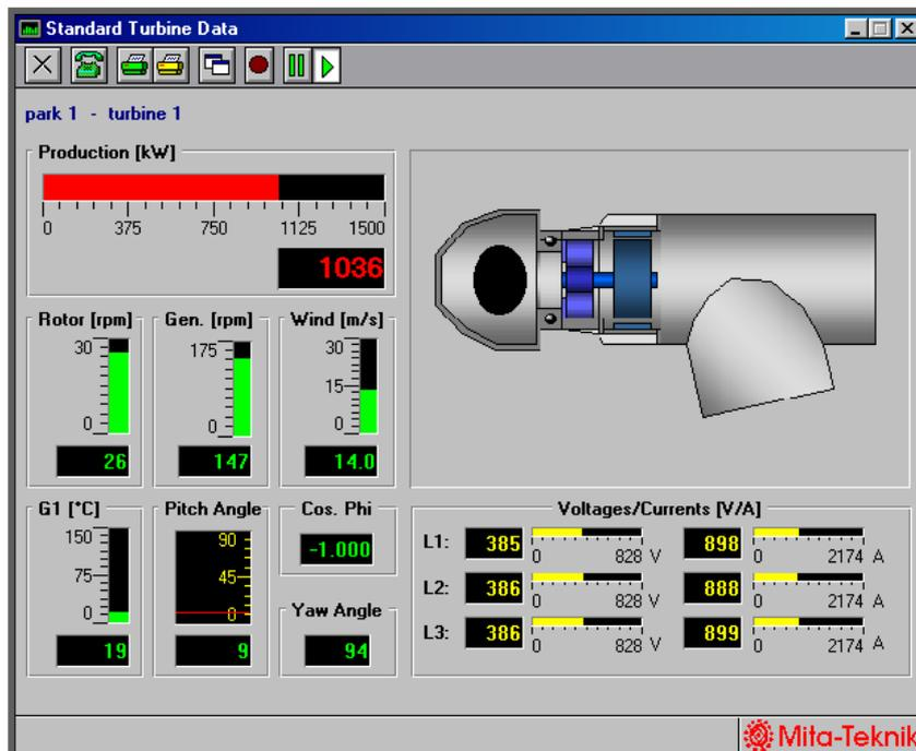
Figura 2. Schermata tipica del sistema SCADA
