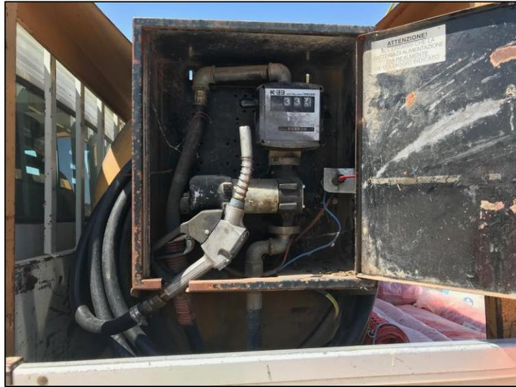
*Erogatore per combustibile con chiave di blocco accensione*
