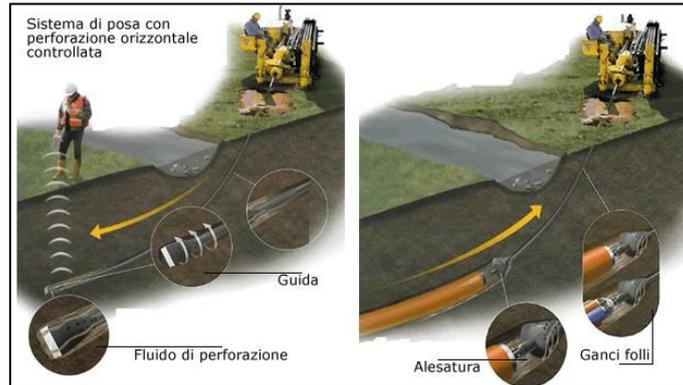
*Posa in opera tubazione per alloggio cavi*
