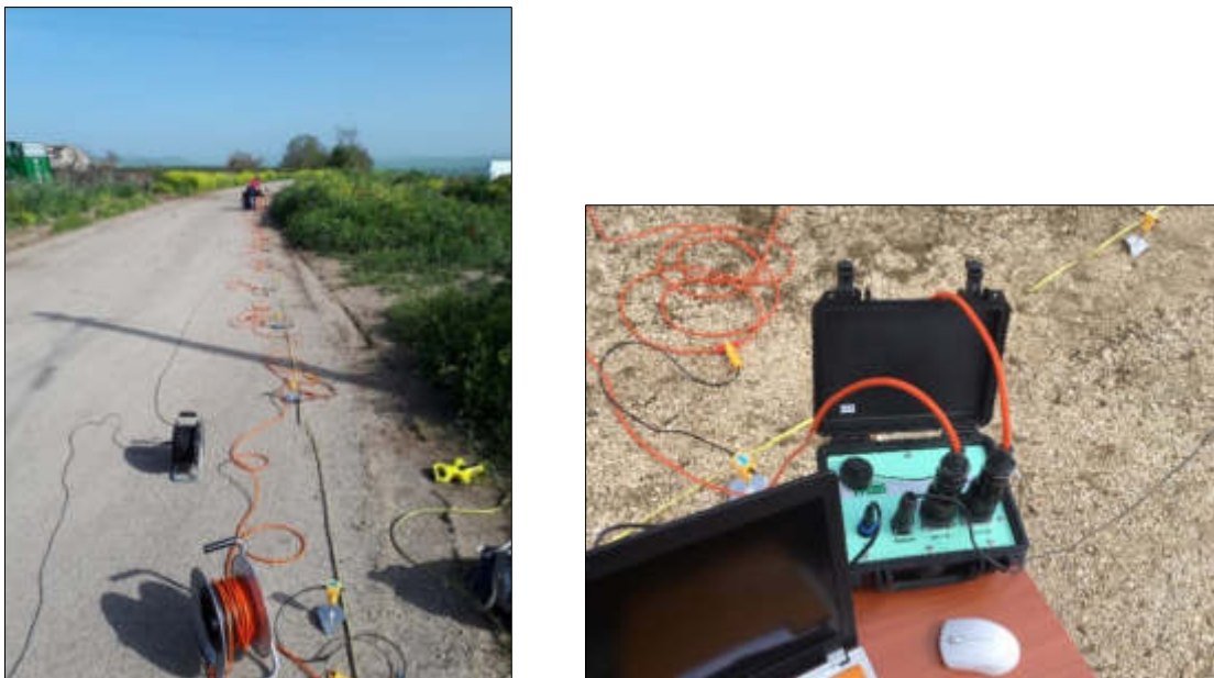
Fig. 5 – Stendimento sismico per indagine a rifrazione SR e di tipo MASW MW (a sinistra). Sismografo GEA 24 della PASI (a destra).
