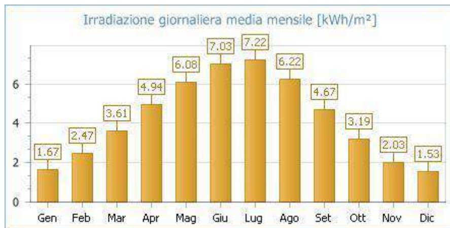
Figura 4.2. – Irradiazione giornaliera media mensile sul piano orizzontale [kwh/m 2 ]- fonte dati: uni 10349 – località di riferimento: Potenza (pz)/Matera (mt)
