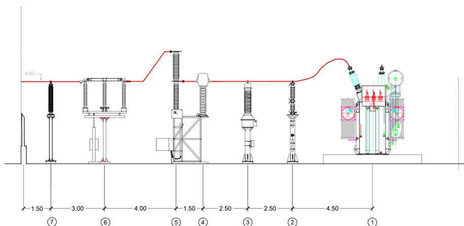
PIANTA E SEZIONE BB' - TRASFORMATORE
