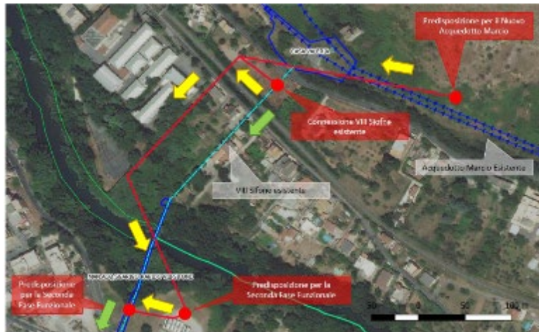
Figura 2: Schema dei tratti dell'opera in progetto in affiancamento alla linea esistente.
