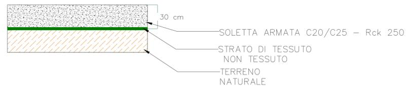
PISTA E PIAZZALE DI CANTIERE – SEZIONE TIPO
