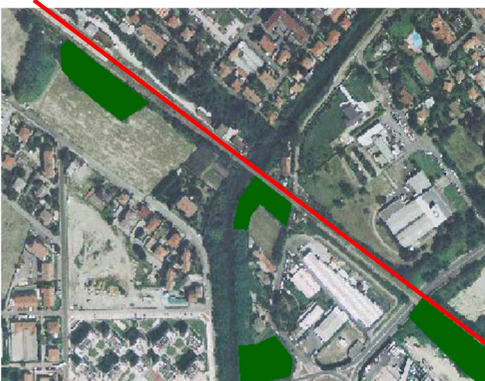
Figura 12-5 - Vincolo "Territori coperti da boschi (art. 142 lett. g)" in corrispondenza del Canale Villoresi (area tecnica Villoresi), nel comune di Parabiago. In rosso è riportato il tracciato della linea in progetto.
