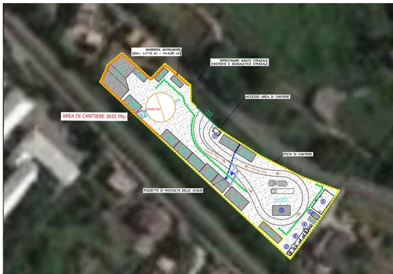
Figura 8. Layout di cantiere area cantiere PZ2
