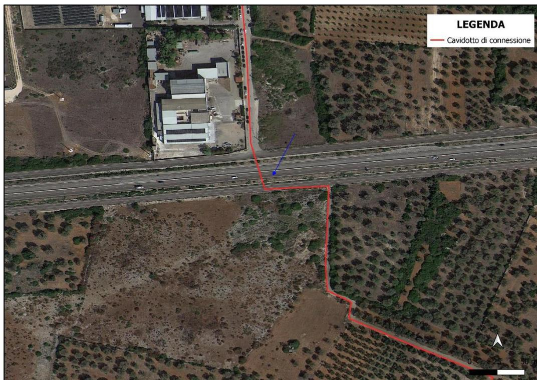
**Figura 14: Interferenza cavidotto di connessione con SS7 ter**
