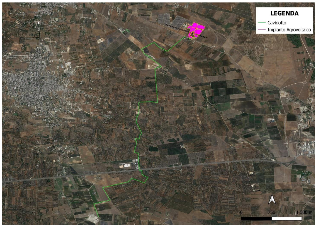
Figura 9:Layout impianto e cavidotto
