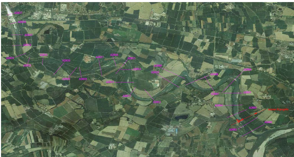
Figura 126: Ortofoto dell’area di interesse con l’indicazione delle sezioni desunte dal PAI e la sezione di progetto. L’area modellizzata ai fini del presente studio si estende dal ponte ferroviario di Pizzighettone (monte) a poco a monte della confluenza in Po (valle).
