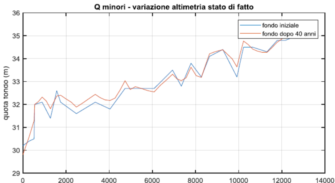
Figura 143: confronto tra le quote del fondo dello stato di fatto attuale (fondo iniziale) e quelle del fondo dopo 40 anni senza progetto - con portate minori
