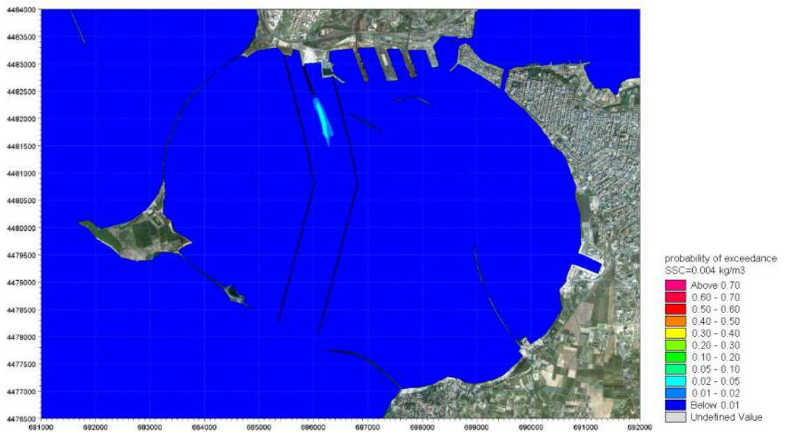
Figura 7-19 Probabilità di superamento della soglia di concentrazione di sedimenti sospesi pari a 0.004kg/m 3 nel layer più profondo durante i 15 giorni di simulazione nel periodo Autunnale/Invernale in condizioni di attuale traffico navale.
