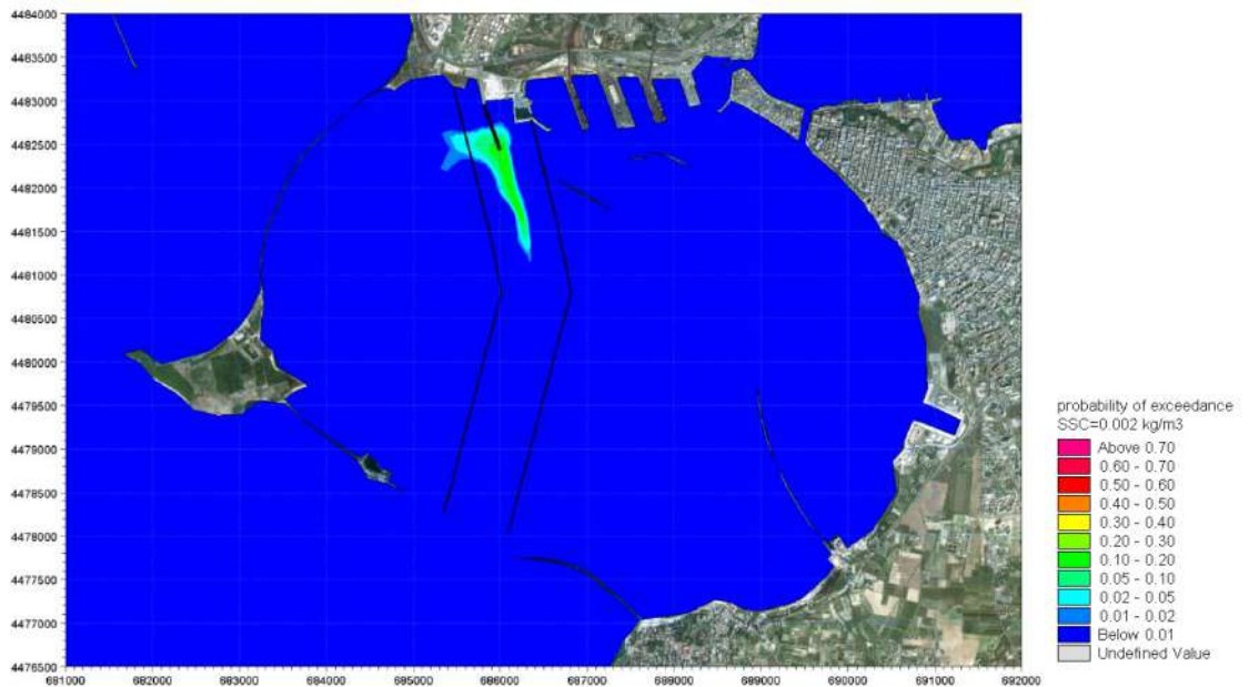
Figura 7-22 Probabilità di superamento della soglia di concentrazione di sedimenti sospesi pari a 0.002kg/m 3 nel layer più profondo durante i 15 giorni di simulazione nel periodo Primavera/Estivo in condizioni di attuale traffico navale.
