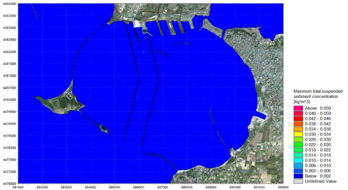
Figura 7-8 Distribuzione della concentrazione massima di sedimento sospeso nel layer superiore al layer 2 (layer 3) durante i 15 giorni di simulazione nel periodo Autunnale/Invernale in condizioni di attuale traffico navale.
