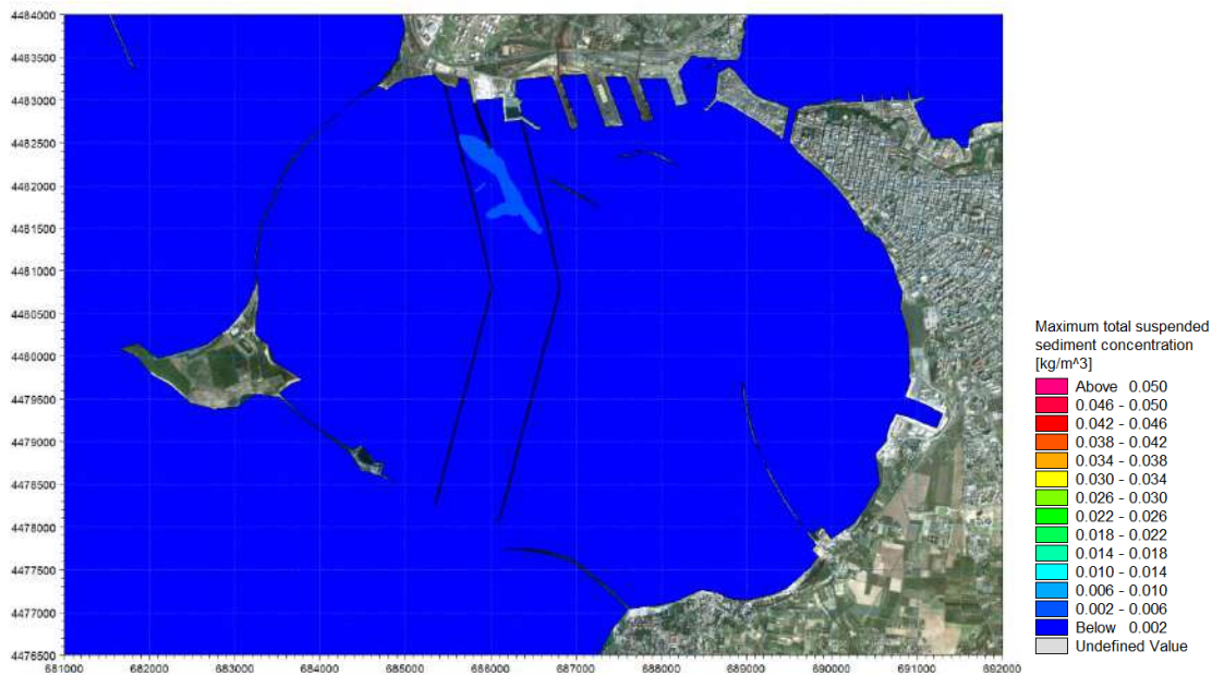
Figura 7-7 Distribuzione della concentrazione massima di sedimento sospeso nel layer superiore al layer 1 (layer 2) durante i 15 giorni di simulazione nel periodo Autunnale/Invernale in condizioni di attuale traffico navale.
