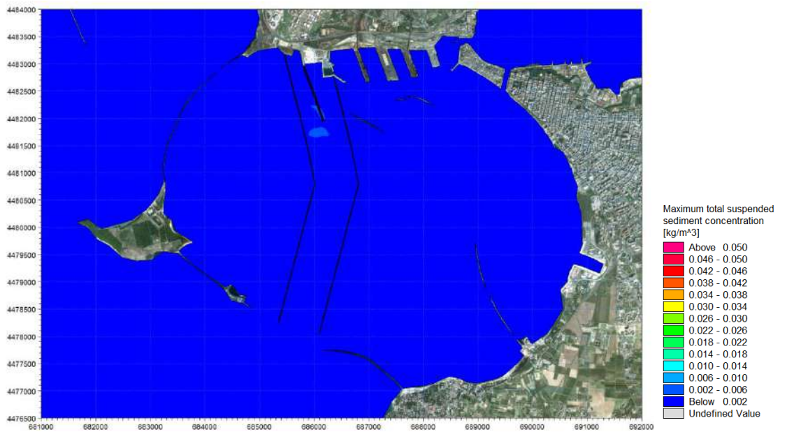
Figura 7-11 Distribuzione della concentrazione massima di sedimento sospeso nel layer superiore al layer 2 (layer 3) durante i 15 giorni di simulazione nel periodo Autunnale/Invernale in condizioni di futuro traffico navale.
