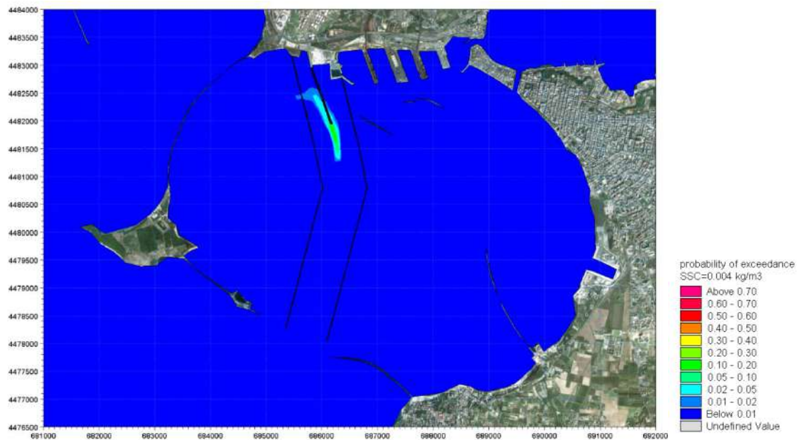
Figura 7-25 Probabilità di superamento della soglia di concentrazione di sedimenti sospesi pari a 0.004\text{kg/m}^3 nel layer più profondo durante i 15 giorni di simulazione nel periodo Primavera/Estivo in condizioni di futuro traffico navale.
