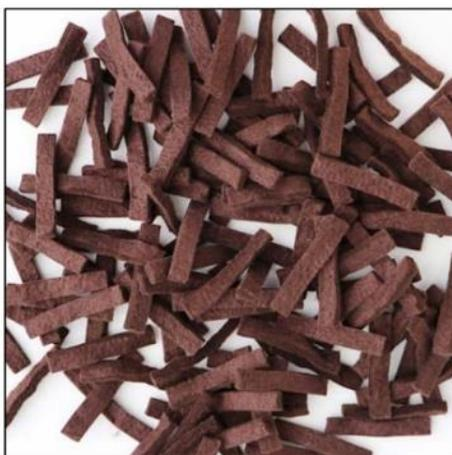
Figura 2.3 Esempio di ritentori idrici di geotessuto.
