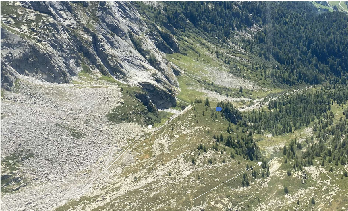
Foto 6.2 – Vista da elicottero della zona dove è previsto il sostegno "BP13"; con le frecce si indica la divisione del flusso lungo i due principali impluvi, con il punto blu la posizione del sostegno.
