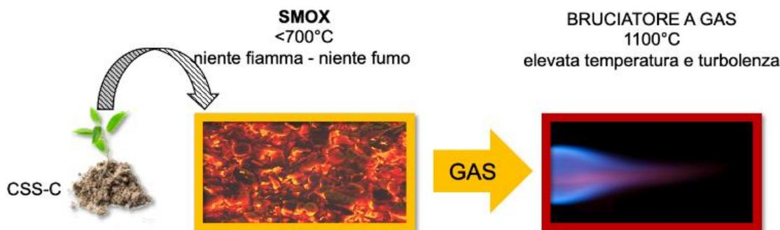
La cella SMOX è un dispositivo di ossidazione parziale di tipo «updraft» utilizzato per dividere le sostanze volatili dalle frazioni solide contenute nella carica.
