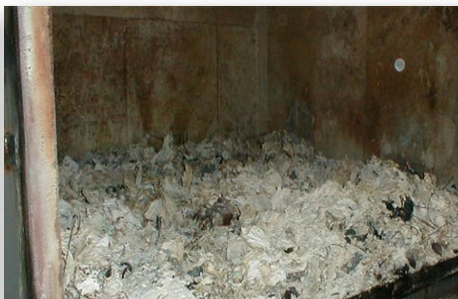
Le ceneri pesanti generate dal processo di smoldering, a causa del lungo tempo di permanenza nelle celle, alle temperature adottate, alla naturale presenza di umidità e di minerali catalizzatori della reazione del gas d'acqua, sono completamente ossidate (inerti), non fuse, e con un contenuto di carbonio molto basso (< 1%). Queste caratteristiche consentono l'utilizzo delle ceneri pesanti nel settore delle costruzioni.
