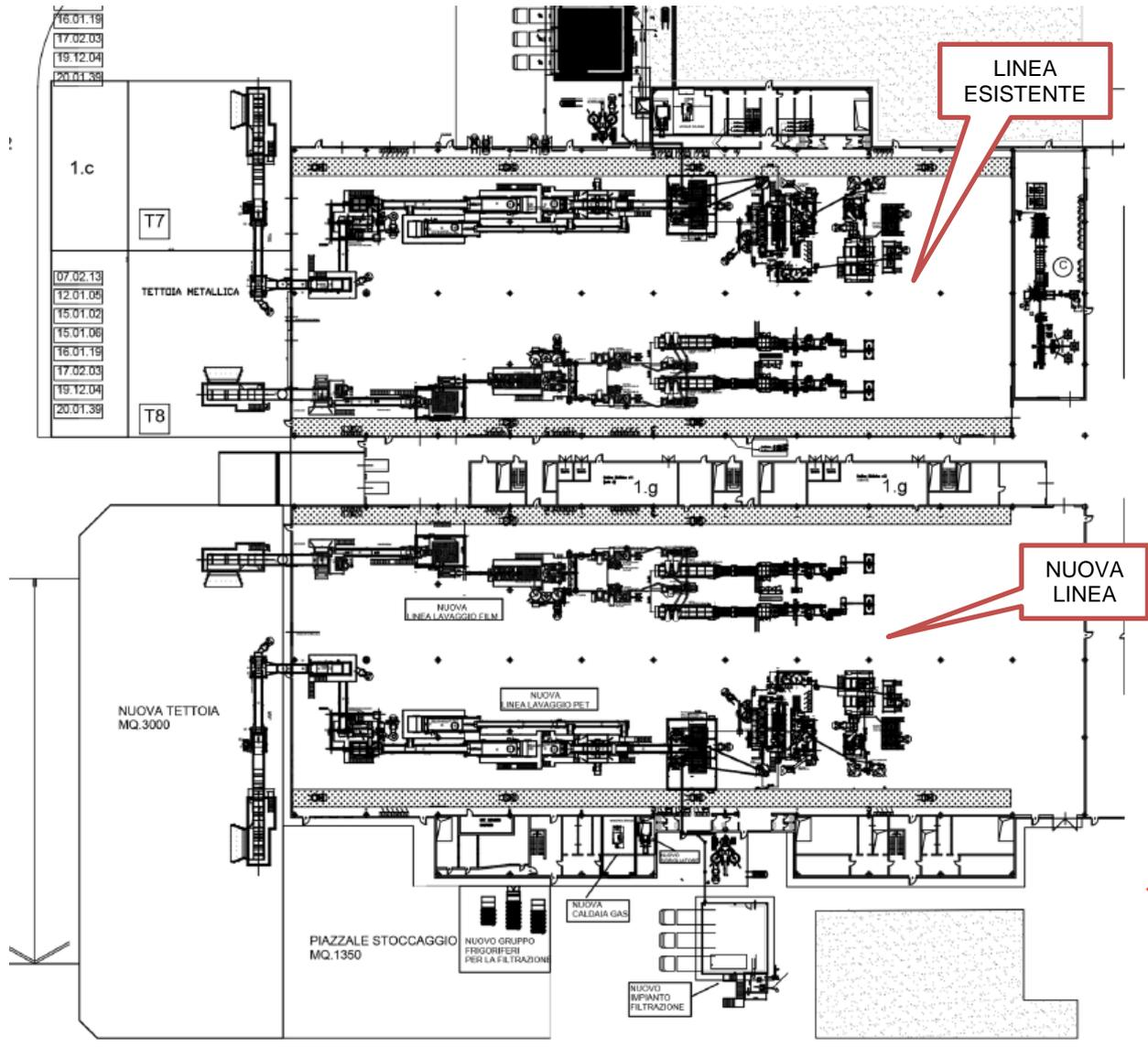
**Figura 4-2: Stralcio planimetria stato di progetto: "raddoppio" della LINEA CSS PER LA SELEZIONE DI RIFIUTI PLASTICI DA RACCOLTA DIFFERENZIATA**
