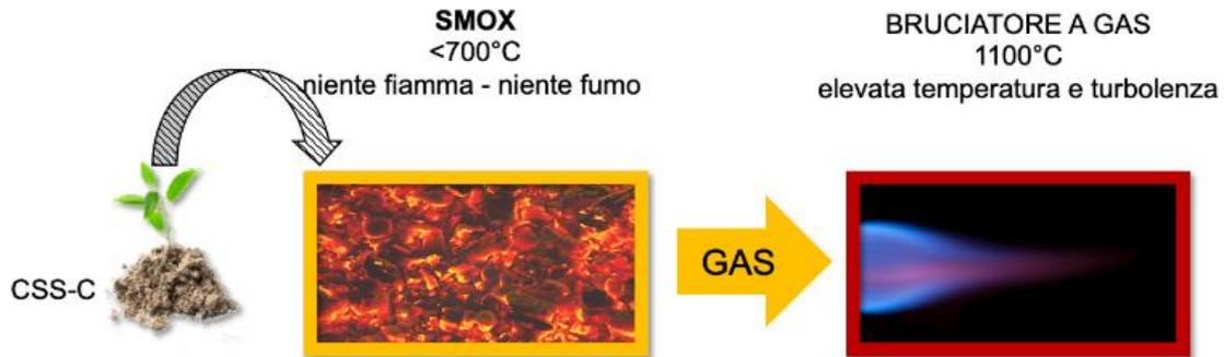
La cella SMOX è un dispositivo di ossidazione parziale di tipo «updraft» utilizzato per dividere le sostanze volatili dalle frazioni solide contenute nella carica.
