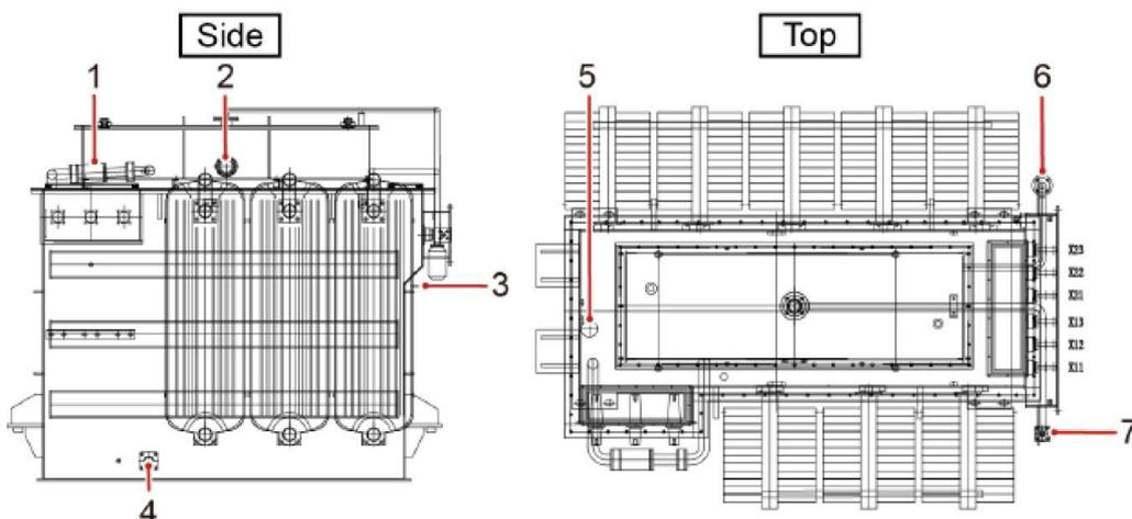
Figura 4 – Esempio di trasformatore ad olio
