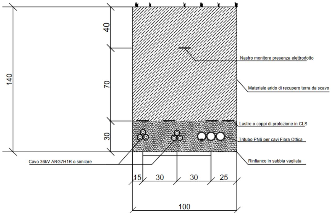
Figura 4 - Sezione tipo su terreno vegetale
