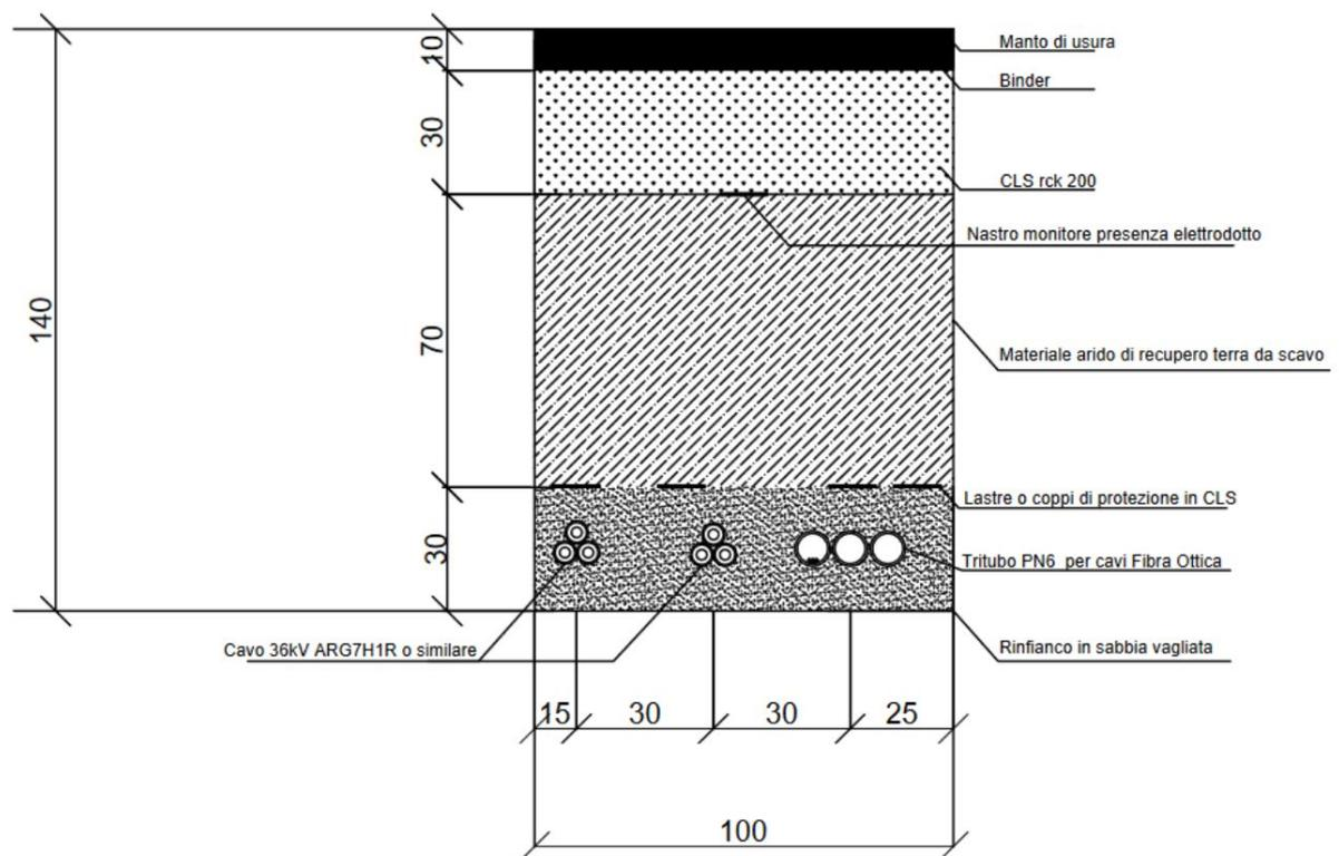
Figura 3 - Sezione tipo su manto stradale
