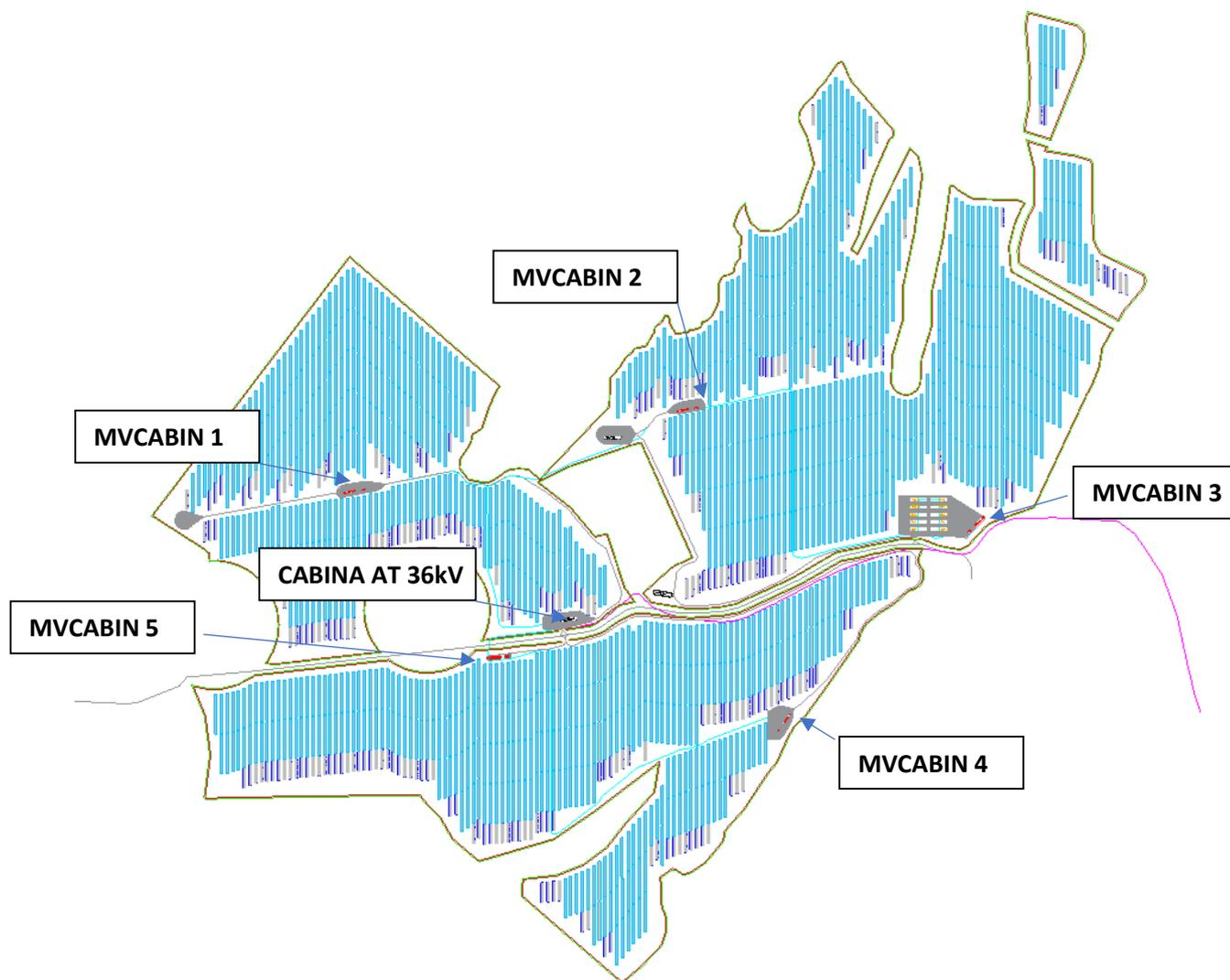
**Fig.5**– Impianto fotovoltaico posizione delle cabine
