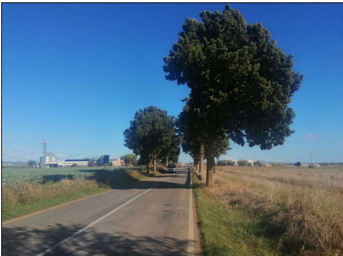
**Foto n. 10**– Il cavidotto sempre nel contesto agricolo dalla cabina prosegue lungo la S.P. filari di cipressi oltre la banchina le opere di scavo si sposteranno verso il ciglio asfaltato per non danneggiare gli apparati radicali di queste sempreverdi.
