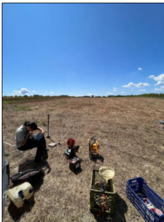
Foto 4: Esecuzione prova geofisica MASW2 – Sito PI02
