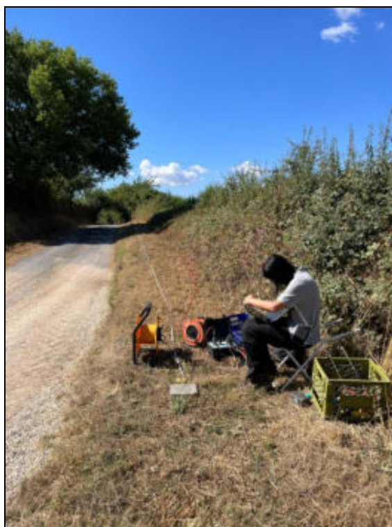
Foto 2: Esecuzione prova geofisica MASW1 – Sito PI03
