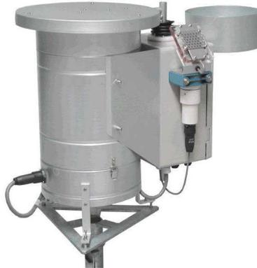
Tale apparecchio si attiva in assenza di precipitazioni raccogliendo il materiale sedimentato. Quest'ultimo viene poi valutato per microscopia ottica automatica dopo essere stato raccolto su adeguato vetrino di osservazione. La foto di seguito riportata si riferisce ad un campione di particolato atmosferico sedimentato.
