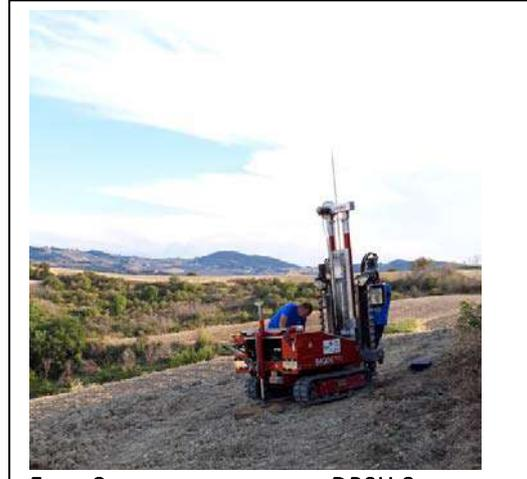
FOTO 8 - ESECUZIONE PROVA DPSH 8
