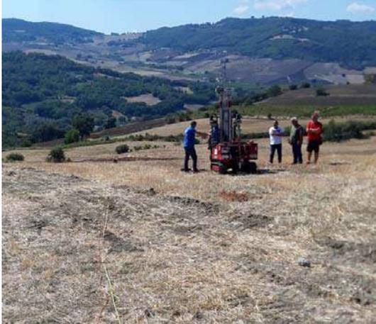
FOTO 1 - ESECUZIONE PROVA DPSH 1
