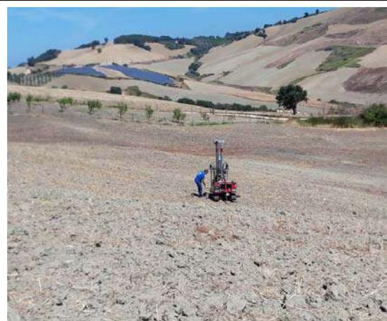
FOTO 2 - ESECUZIONE PROVA DPSH 2
