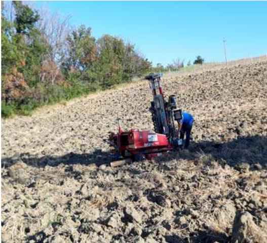
FOTO 7 - ESECUZIONE PROVA DPSH 7
