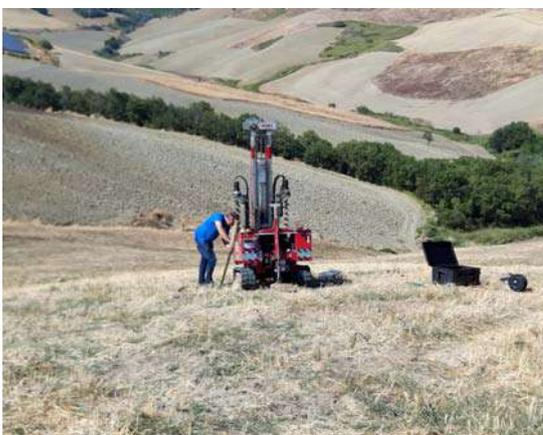
FOTO 5 - ESECUZIONE PROVA DPSH 5
