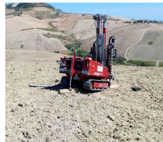
FOTO 4 - ESECUZIONE PROVA DPSH 4
