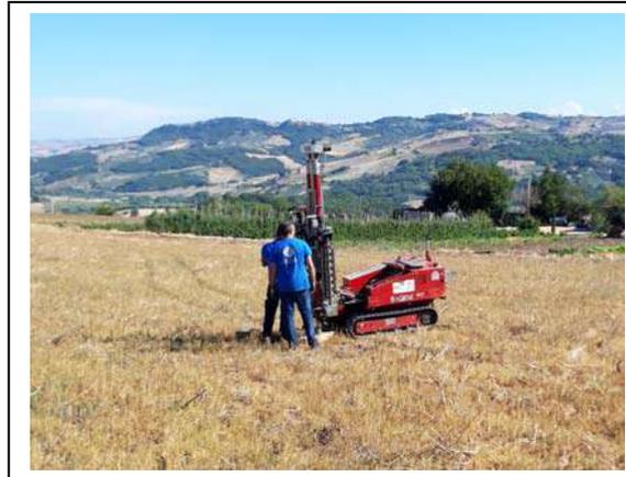
FOTO 6 - ESECUZIONE PROVA DPSH 6
