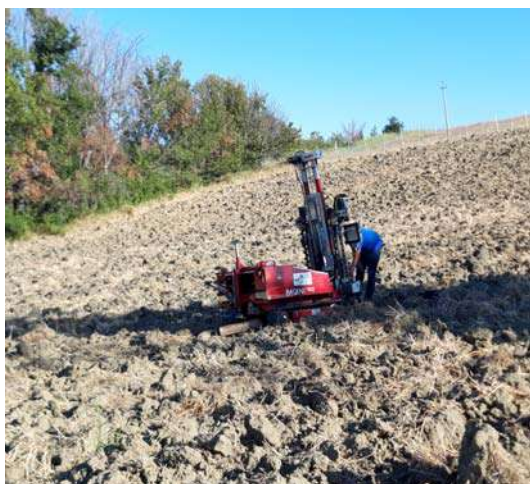
FOTO 7 - ESECUZIONE PROVA DPSH 7
