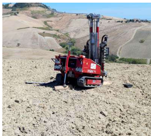
FOTO 4 - ESECUZIONE PROVA DPSH 4
