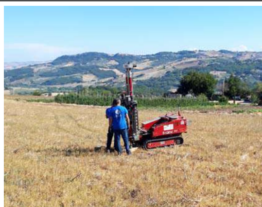
FOTO 6 - ESECUZIONE PROVA DPSH 6
