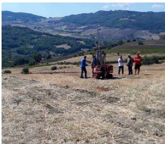
FOTO 1 - ESECUZIONE PROVA DPSH 1
