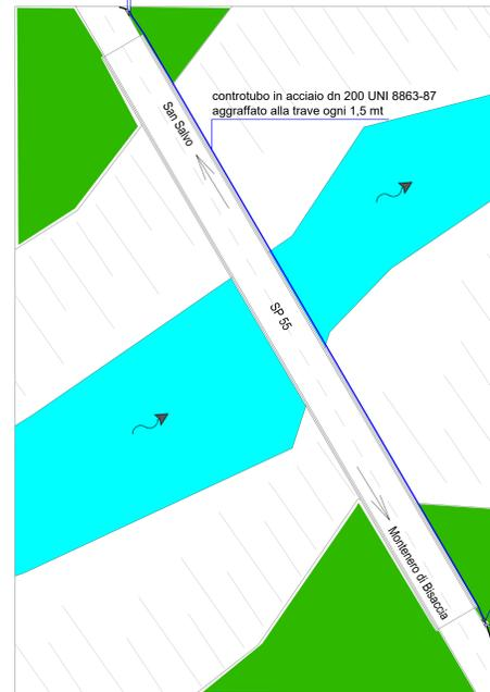
controtubo in acciaio dn 200 UNI 8863-87
