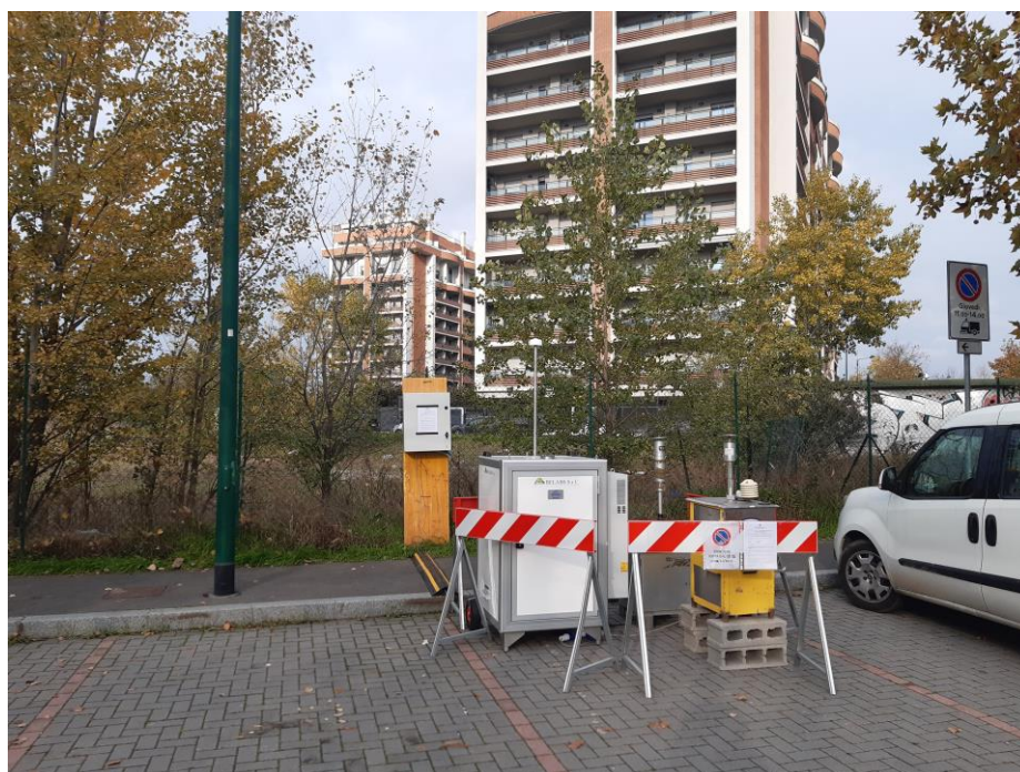
Figura 8 Esempi strumentazione di monitoraggio NO x
