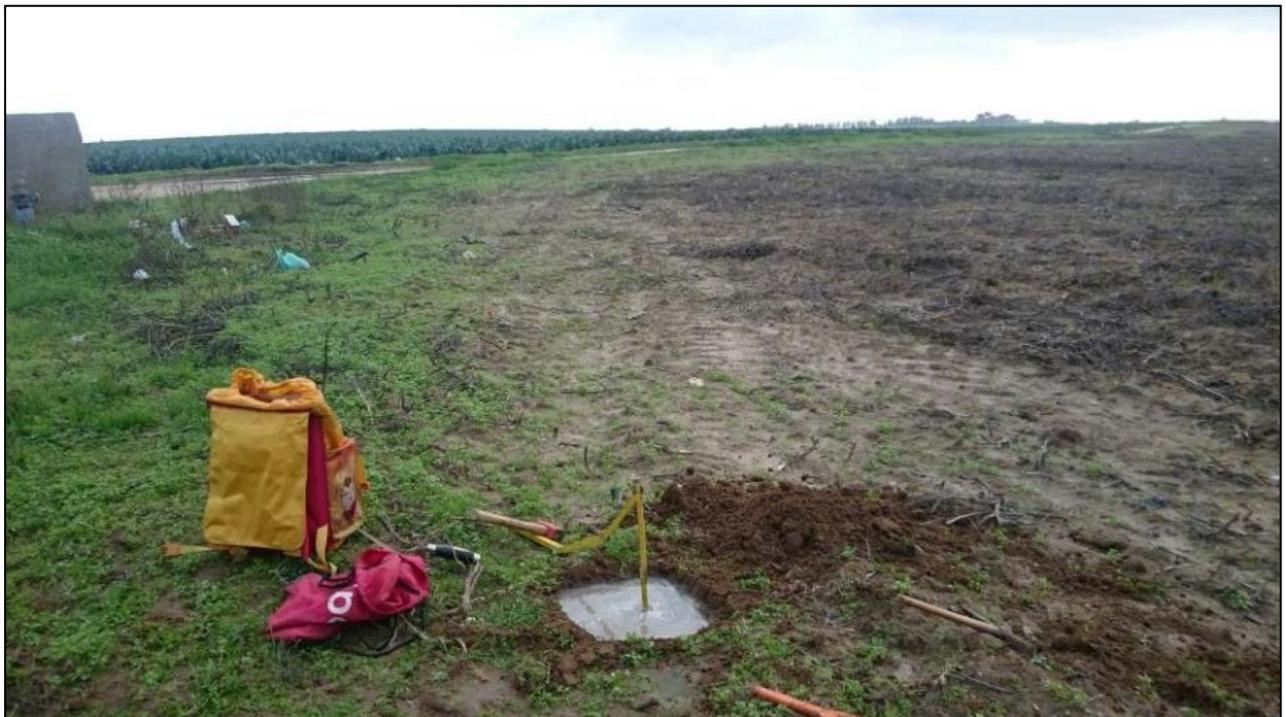
**FIGURA 52 – PROVA DI PERMEABILITÀ A CARICO VARIABILE “LAGO LUNGO”**
