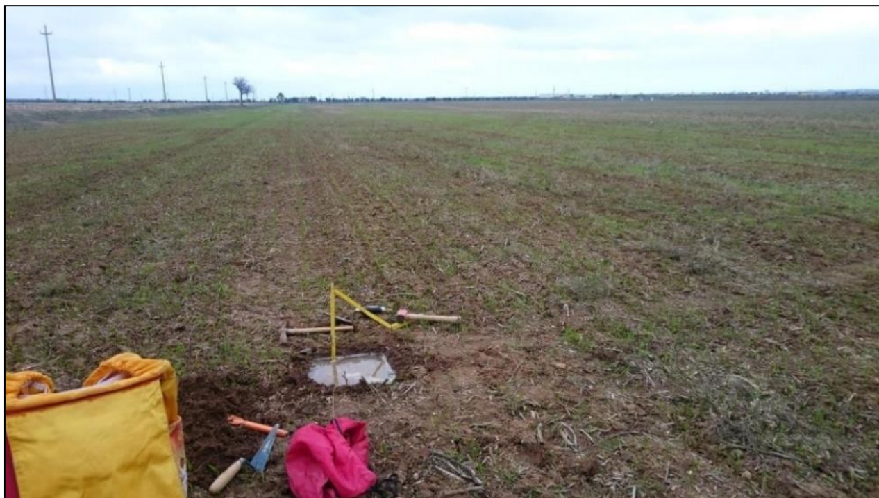
FIGURA 51 – PROVA DI PERMEABILITÀ A CARICO VARIABILE “GIRIFALCO”
