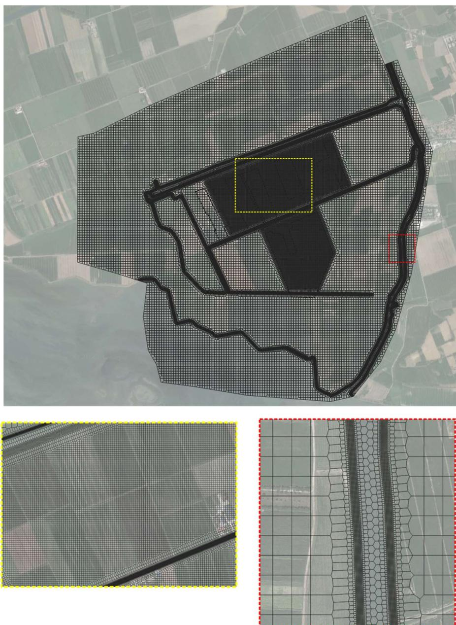
Figura 15. Geometria della mesh di calcolo del modello numerico implementato.
