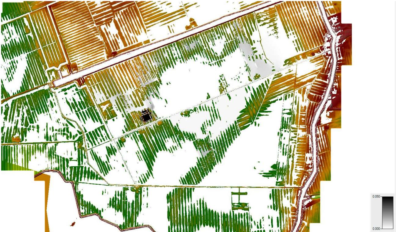
Figura 45 Confronto fra livello idrico allo stato di progetto e allo stato di fatto. In nero i punti con differenza superiore ai 5 cm.
