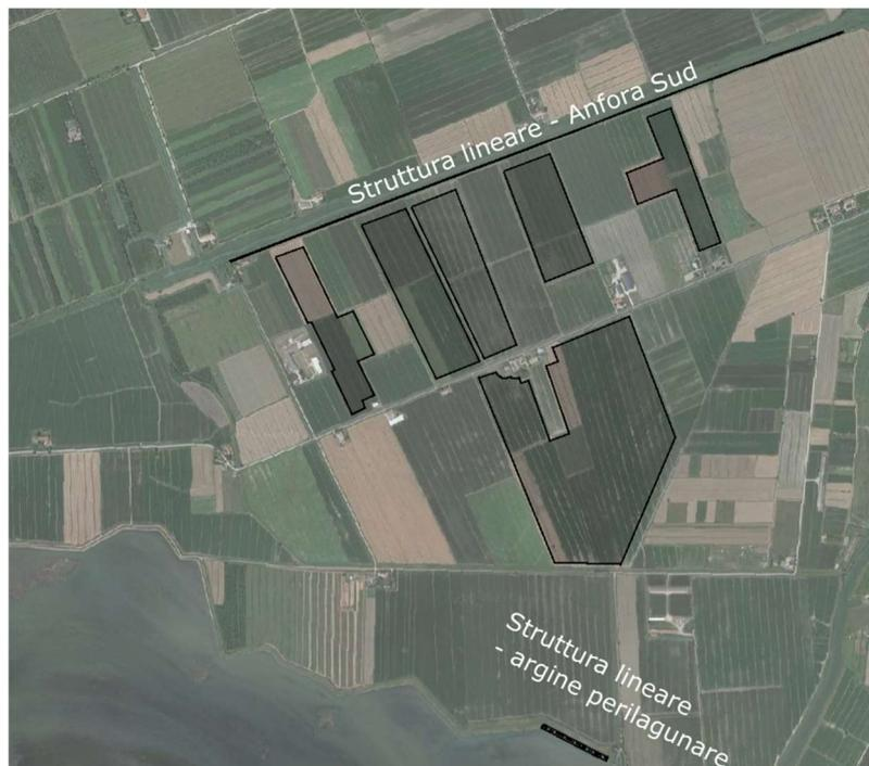
Figura 17. Posizionamento delle strutture lineari per la modellazione delle breccie arginali.
