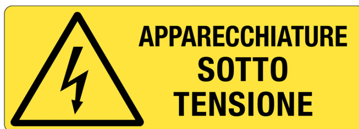
4.3 Indicazione dell'area con apparecchiature sotto tensione
