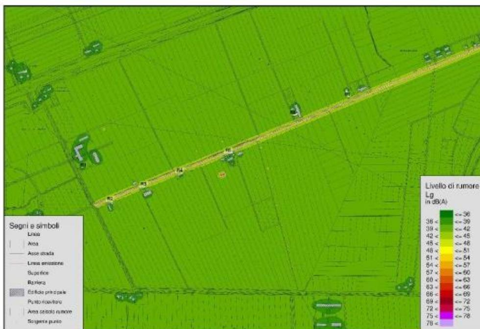
**Figura 8.35:** Stato di progetto campo fotovoltaico con contributo ambiente esterno – periodo diurno
