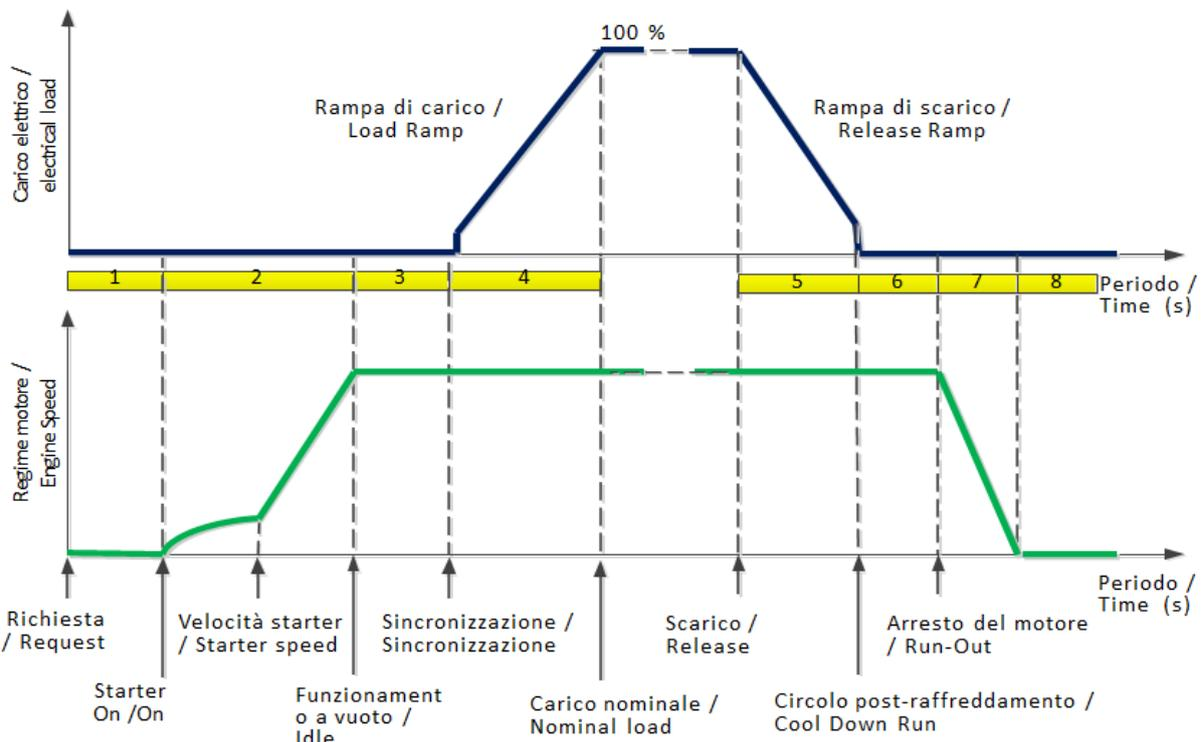
I seguenti tempi delle singole sezioni di avvio fino al carico nominale sono **valori indicativi** per un avvio completamente automatico in condizioni di preriscaldamento per il funzionamento in parallelo. Si osserva solo il tempo totale di avvio nelle varie condizioni del motore. I singoli periodi di tempo specificati nella tabella non si sommano quindi necessariamente all'indicazione del tempo totale di avvio nel funzionamento in parallelo alla rete.
