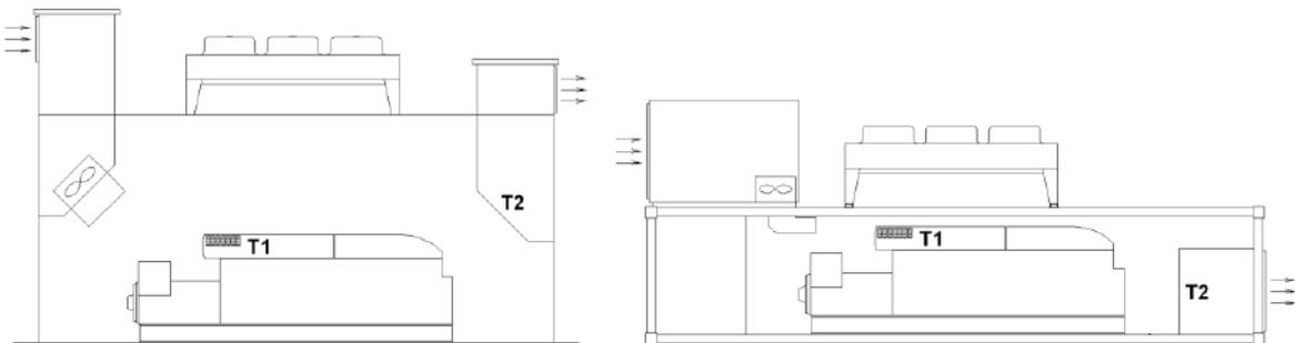
Per mantenere la qualità necessaria dell'aria ed evitare accumuli di gas (si veda il capitolo  $\Leftrightarrow$  Aree soggette al rischio di esplosione TA 1100-0110), occorre rispettare la frequenza di ricambio dell'aria minimo (C). Il calcolo viene effettuato secondo TA 1100-0110 e per gli aggregati JENBACHER è  $C_{min.} = 50h^{-1}$ .
