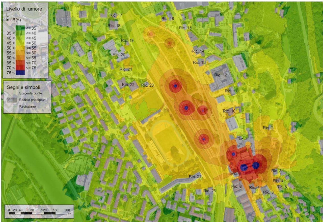
Figura 5 Output del modello di simulazione in planimetria per i cantieri CO.02 e AT.01 nel periodo di riferimento diurno
