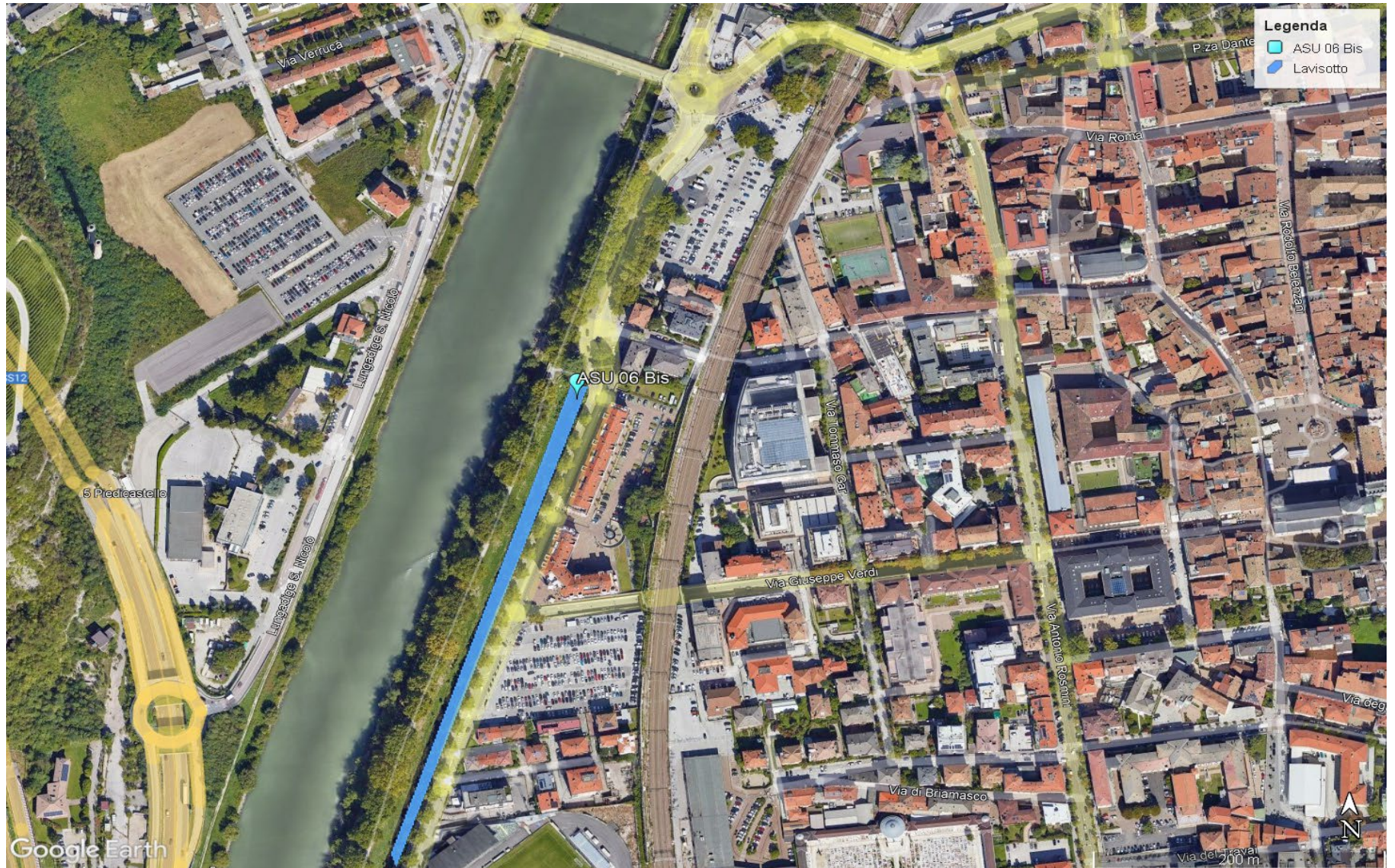
Figura 5 - Ubicazione del punto ASU 06 Bis lungo il canale Lavisotto. Spostato a seguito della riunione del 23/11/2023 al fine di intercettare gli scarichi delle acque di dilavamento del cantiere operativo CO.02
