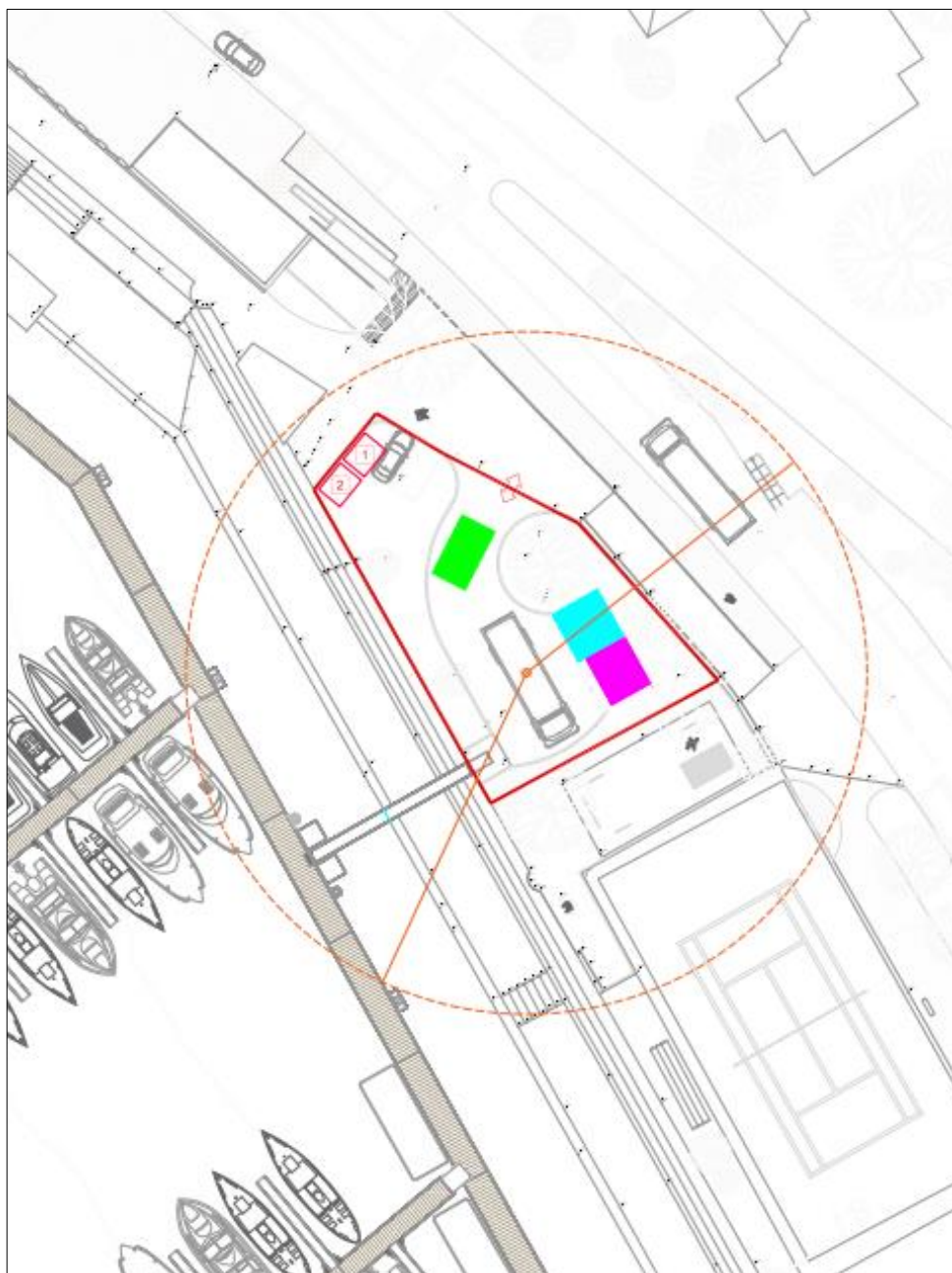
Figura 3.16 Lago Maggiore - Nuovo porto turistico di Pallanza. Delimitazione area di cantiere/stoccaggio a terra a Pallanza
