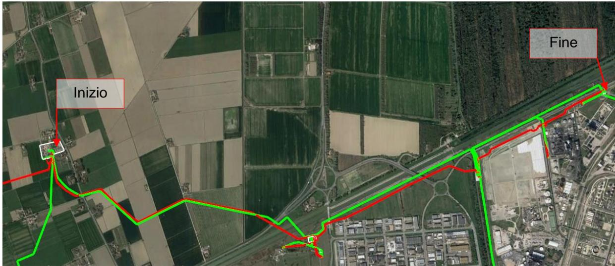
**Figura 3/2** – Stralcio immagine satellitare (in rosso metanodotto In progetto, in verde tratti in dismissione)
