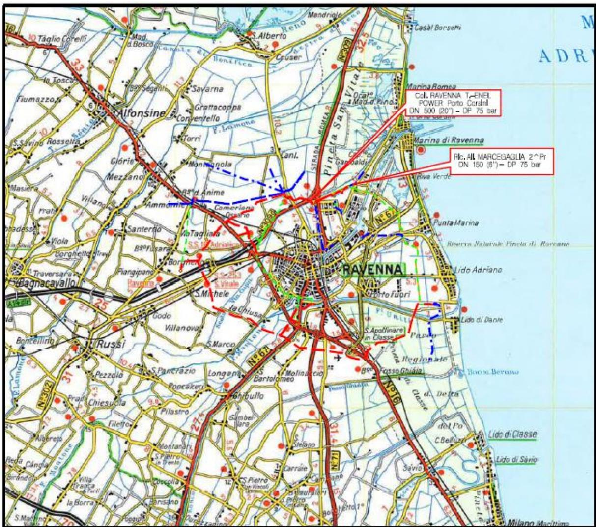
Figura 2/1 – Stralcio Atlante 1:200.000 con localizzazione delle opere (in rosso metanodotti In progetto, in verde metanodotti In dismissione, in blu metanodotti esistenti)
