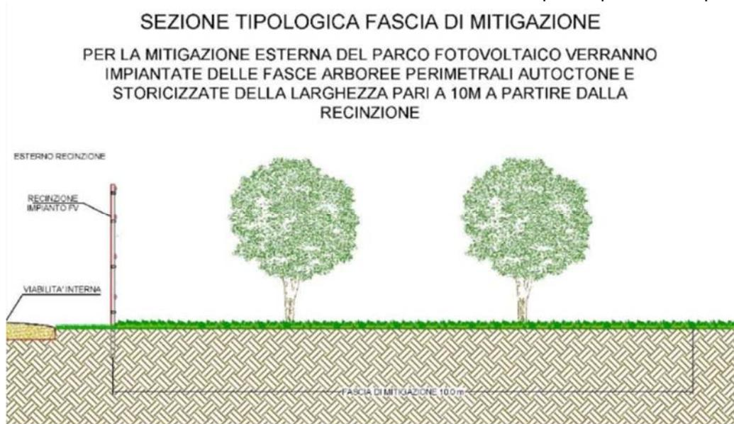
Figura 66 – Sezione tipologica fascia arborea perimetrale esterna alla recinzione con Olivo
