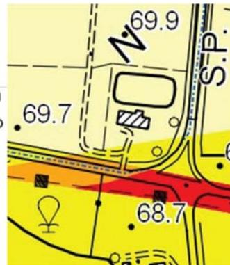
Figura 102 - Particolare del tratto di interferenza del cavidotto con l'area a rischio idraulico R3. – Rischio idraulico - RAMASIS0009A0\_SIA04.3 - Analisi componente suolo PAI Idraulica Pericolo e Rischio
