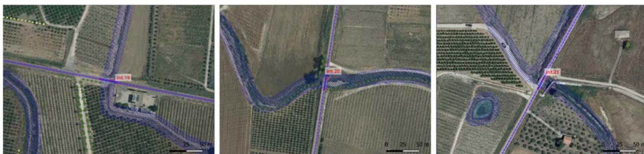
Figura 94 - Interferenze del cavidotto con il reticolo idrografico superficiale e modalità di risoluzione (T.O.C.)
